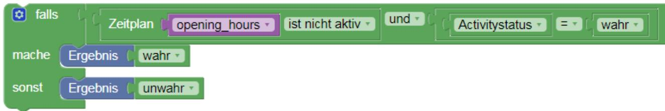
Im dritten Beispiel soll immer dann eine Meldung erzeugt werden, wenn die Lüftungsanlage eingeschaltet ist, obwohl die zugehörige Filiale geschlossen ist.
